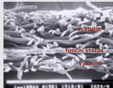
Průřez třívrstvou superdifúzní fólií (výztuha - funkční vrstva - výztuha)
